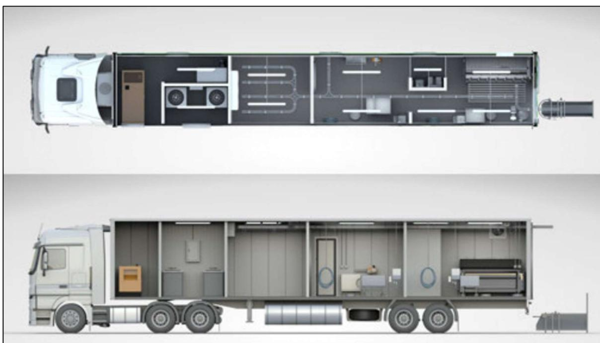
**Ilustración 12. Planta y corte del "Proyecto Matadero Móvil - INAC" Fuente. TecnoIncar – Tecnología Industria Cárnica.**
